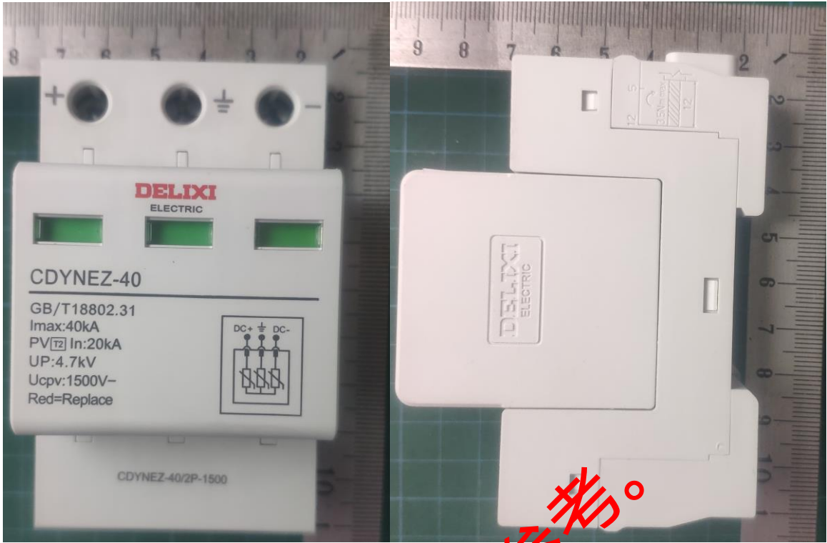
CDYNEZ-40/2P-1500 正面及侧面 I_n=20\text{kA} , I_{\text{max}}=40\text{kA} , U_{\text{CPV}}=1500\text{V} , U_p=4.7\text{kV}
