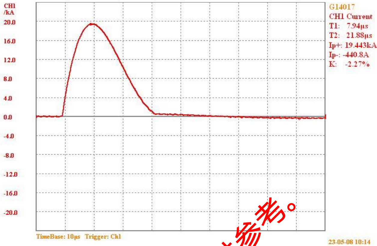
样品在 I_n=20\text{ kA} 下的电流波形
